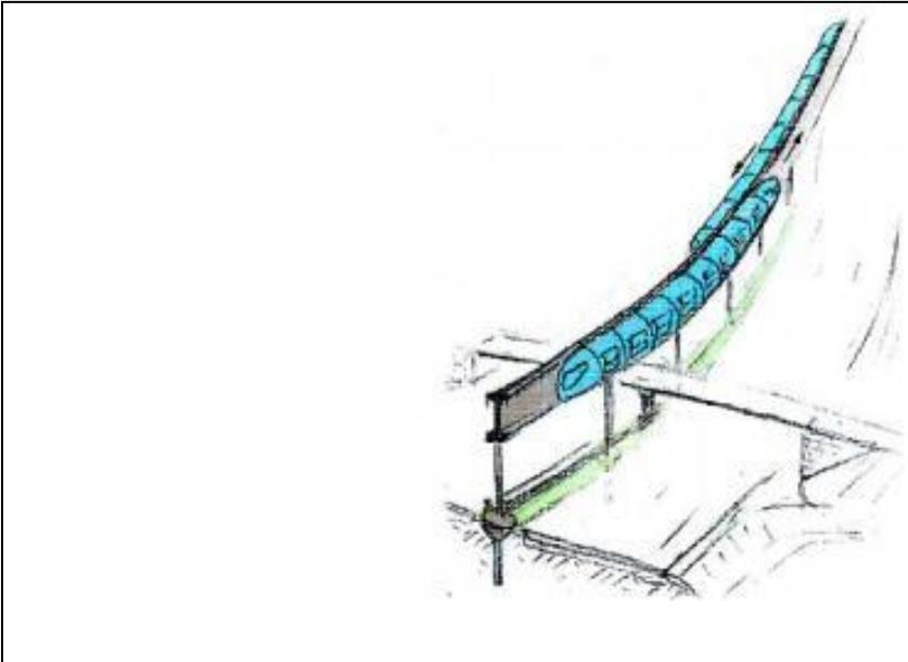
Die heutige Bautechnik für die bekannte „Magnetschwebbahn“ sieht eine jeweils nur einspurig nutzbare Verkehrsstrasse auf balkenartigen Stahlbetonbauteilen vor, die auf Stahlbetonrahmen aufgelegt sind. Der notwendige Grunderwerb ist dabei unerlässlich.
