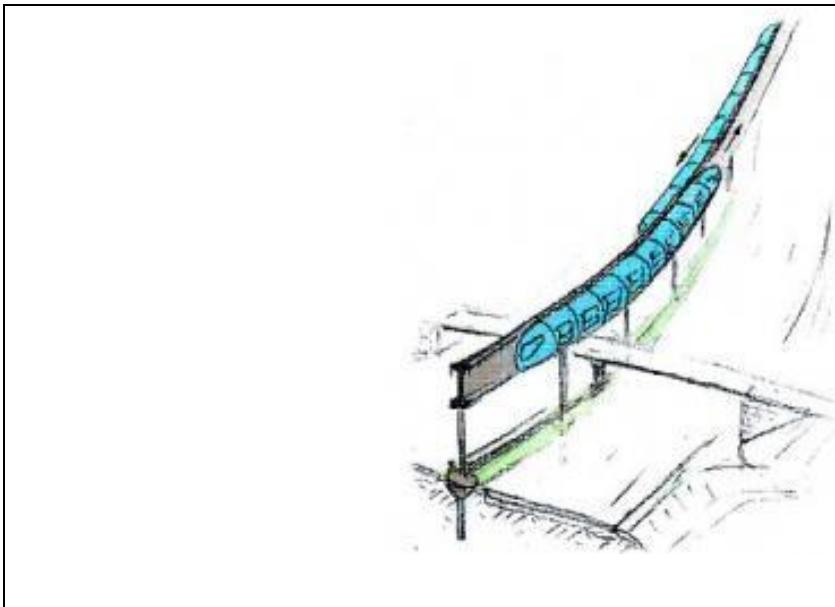
Die heutige Bautechnik für die bekannte „Magnet-schwebebahn“ sieht eine jeweils nur einspurig nutzbare Verkehrstrasse auf balkenartigen Stahlbetonbauteilen vor, die auf Stahlbetonrahmen aufgelegt sind. Der notwendige Grunderwerb ist dabei unerlässlich.
