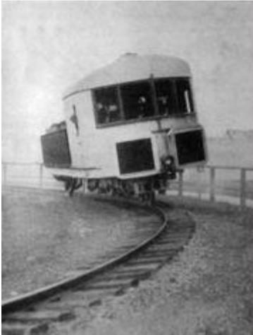
Kreiselstabilisierte Einschienenbahn von Brennan (1907)
