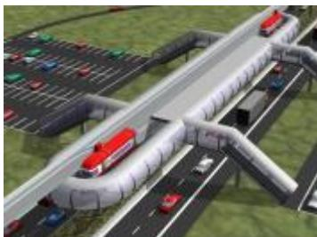
Für kurze Distanzen (ÖPNV) eignet sich insbesondere der Shuttle-Betrieb. Eine spezielle Weichenkonstruktion erlaubt hier die Kombination von ÖPNV und ÖPFV. Ein weiterer Vorteil, auf langen Strecken über der Stadt zu fahren und nicht im Dunkeln unter der Erde, liegt auf der Hand: Fahrgäste erleben ihre Stadt aus hervorragender Position, Orientierungen fallen leichter als im Untergrund.
